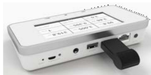
Mesure de la forme d'onde et visualisation sur PC Communication sur PC par mode Bluetooth
